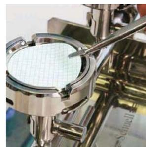
图4 过滤完毕，拾取滤膜、培养和观察。
