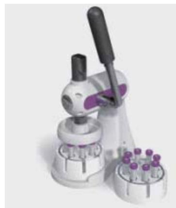
1-位压缩仪/8位压缩仪与Mini-UniPrep G2配合可高效率制备大量样品
